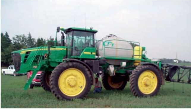
Figura 18. Sistema de aplicación de abono líquido variable autocorregido con sensor hiperespectral "Greenseeker" que calcula el índice de verdor del cultivo (NDVI)
