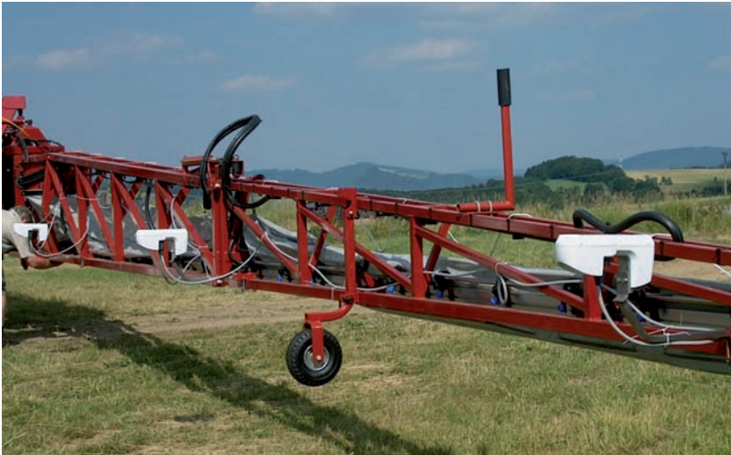
Figura 16. Sistema de montaje de greenseeker en barra de aplicación variable de abono líquido
