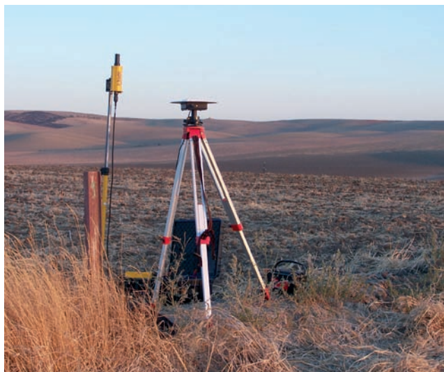
Figura 6. Estacion base para correcciones RTK
