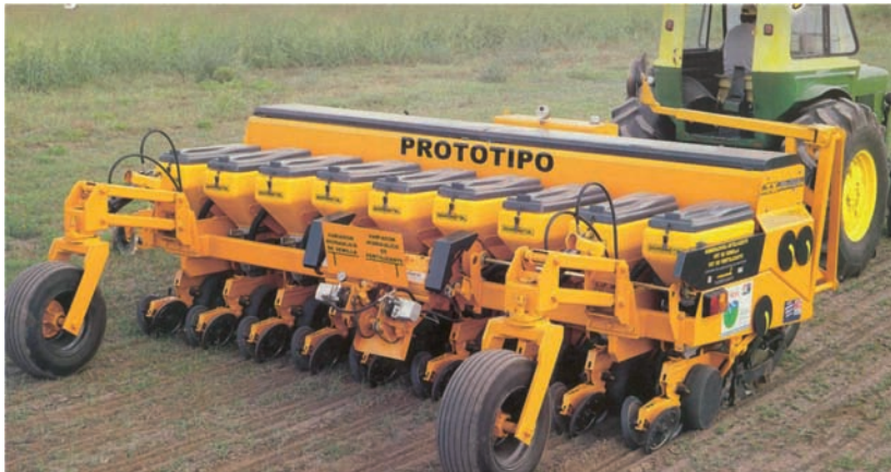
Figura 19. Sembradora adaptada a la distribución variable de semilla
