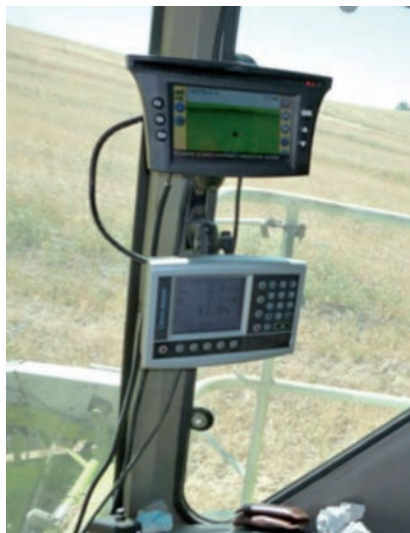
Figura 25. Sistema de ayuda al guiado mediante barra de luces, arriba, y monitor de rendimiento, abajo, montado en cosechadora
