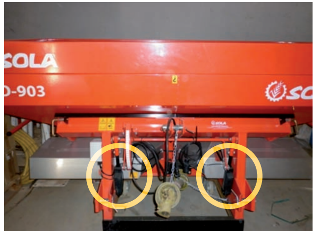
Figura 22. Actuadores eléctricos para la apertura y cierre automáticos de las trampillas de caída de abono
