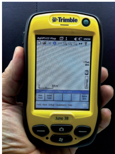
Figura 10. Pocket pc con programa EZ Maps para toma de muestreos en campo.
