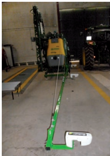
Figura 24. Sensores multiespectrales "Weed-seeker" acoplado en barra de tratamientos
